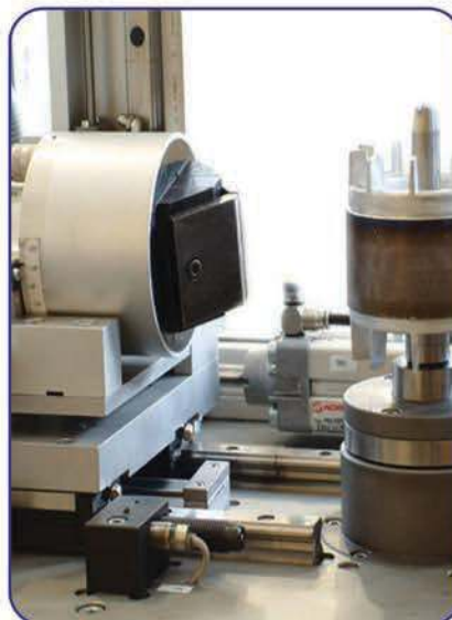
تجهیزات تست روتور RQA/125/Satas 2,RQA/300/ITS
